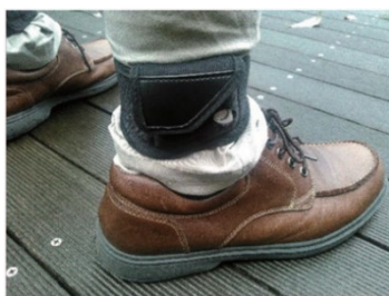
図1. 小型軽量のセンサを取付け、1分程度のセットアップで計測可能
